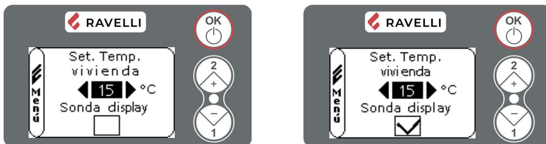
Configure la temperatura deseada con las teclas 1 y 2. Los valores seleccionables son: EXT, de 7 °C a 40 °C, MAN. Hay que seleccionar el valor EXT si se desea utilizar el termostato externo y MAN cuando se desea que la estufa funcione a potencia constante. Para regresar directamente a la pantalla «Inicio», presione las teclas 1 y 2 al mismo tiempo, o bien, presione OK para pasar a «Sonda display».
