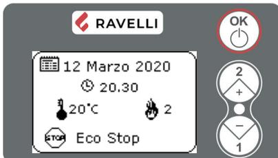
Terminada la fase de apagamiento la pantalla visualizara la fase de ECO STOP. La estufa queda en este estado hasta que la temperatura baja a 15°C, en este momento va a empezar la fase de encendido.
