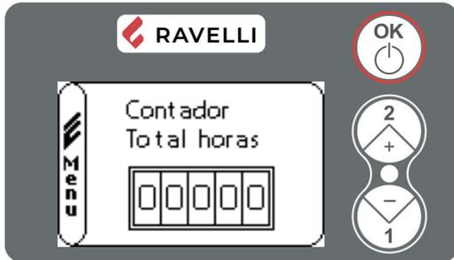
Se accede a la visualización de las horas de trabajo de la estufa. Para ver los diferentes contadores (horas totales, horas parciales y números de encendidos) utilizar los botones 1 y 2.
